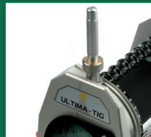
Afvlakken van de wolframelektrode in de 90 graden positie. 1 punt op de gradenverdeelschroef is gelijk aan 0,1 mm afvlakdoormeter.
